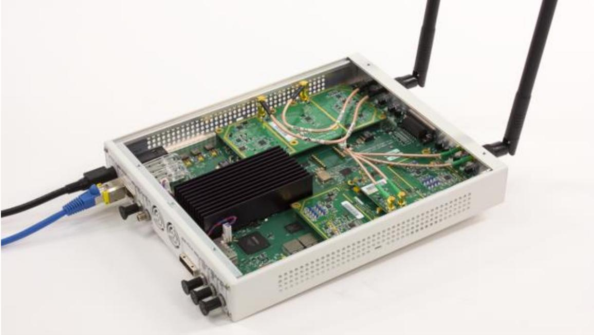
إن ما يعطي الـ SDR قابلية البرمجة programmability هو استخدامه للـ general processors بدلاً من specific processors. الأمثلة على الأولى هي الـ CPU، FPGA، بينما الأمثلة على الثانية هي ASIC. بالطبع لكل نظام مميزات وعيوب. (المميزات والعيوب التي سنذكرها هي عامة لأي تطبيق وليست خاصة بالـ SDR).
