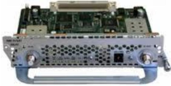
تمثل هذه الوحدة بالمودم الداخلي والمعروف لدى الكثير ومن أهم وظائف هذا الجزء عند الإرسال هو عملية (Multiplexing) والترميز (Encoding) والتضمين (Modulation) أما عند الاستقبال فالعكس تماما أي فك التضمين الذي ذكرناه سابقا (Demodulation) ثم عملية فك التشفير (Decoding) ثم عملية إعادة توزيع الإشارات (Demultiplexing)، بالإضافة إلى التزامن مع باقي وحدات الشبكة بشكل عام.
