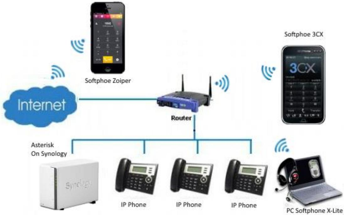
هواتف ال IP Phone تستخدم تقنية Voice over IP (الصوت عبر بروتوكول الإنترنت) مما يسمح إجراء مكالمات تلفونية بواسطة الشبكات التي تعتمد على ال IP مثل الإنترنت بدلا من نظام PSTN - Public switched telephone network الأصلي (المستخدم في شبكات الهاتف الأرضية).
