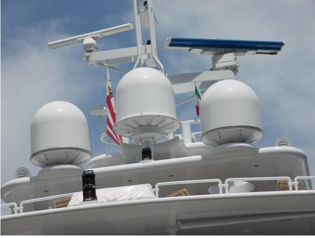
يستخدم الرادار على نطاق واسع في مختلف أنواع السفن وناقلات النفط والبوارج الحربية وحاملات الطائرات حيث يقوم الرادار بتحديد أماكن السفن الأخرى في عرض البحر وكذلك تحديد أماكن الشواطئ والجزر الصغيرة والصخور والجبال الثلجية التي تعترض طريقها مما يجنبها الاصطدام بها. وفي الموانئ يستخدم الرادار لكشف وجود السفن وتحديد بعدها في المياه المحيطة بالميناء وذلك لتنظيم دخولها وخروجها من الميناء. إن تصميم رادارات الملاحة البحرية أصعب بكثير من
