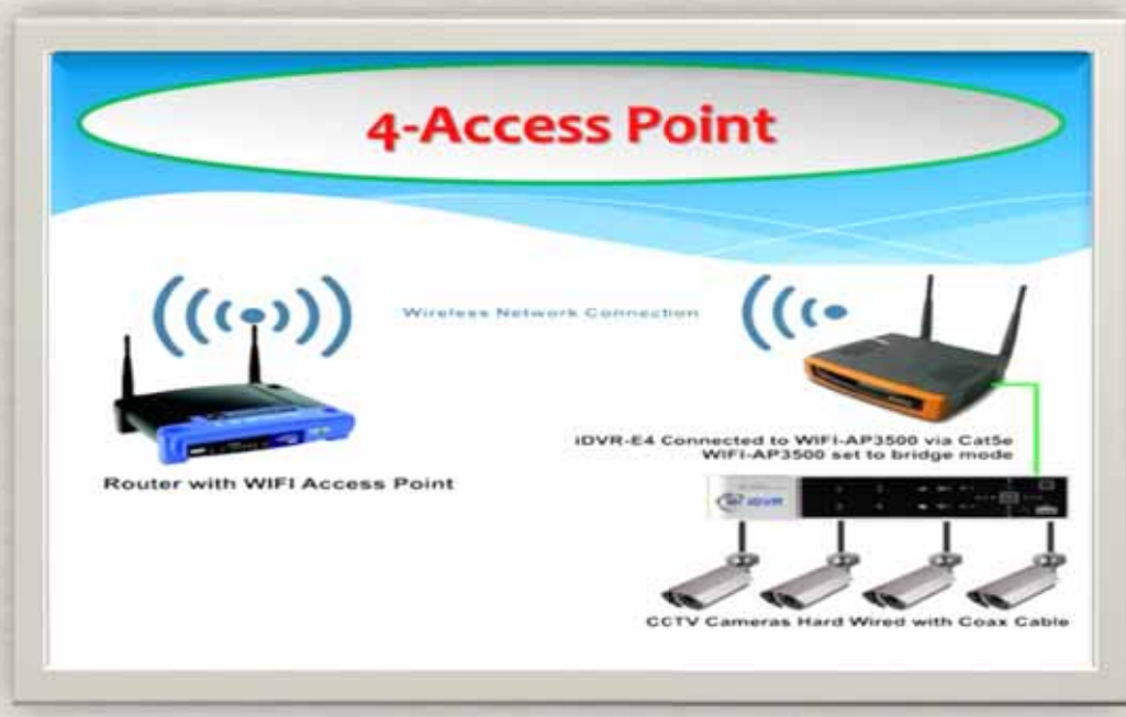
صورة توضح توصيل ال DVR ب Access Point
